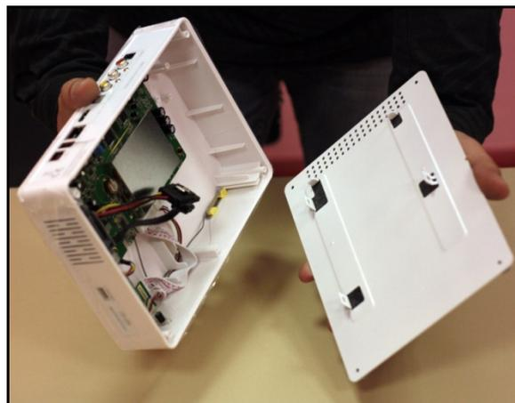
3. Sujete el disco duro y proceda a anclarlo cuidadosamente entre las guías de la tapa
