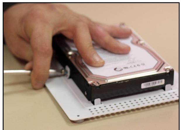
5. Proceda a conectar los cables del interior de la caja del Android al disco duro que ya ha montado en la tapa inferior.
